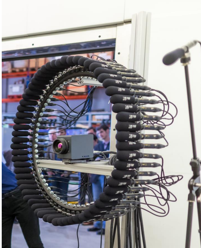
Akustische Kamera mit integrierter Thermokamera
